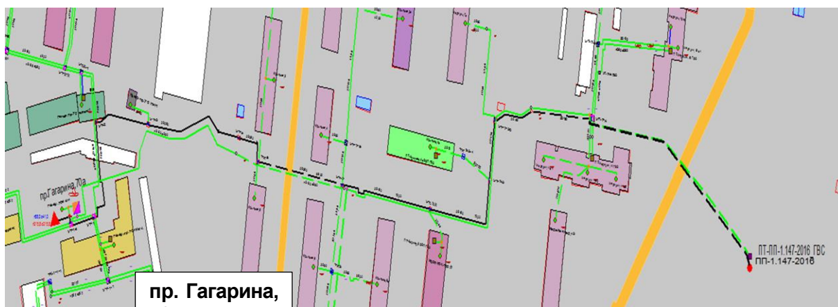
Рисунок 2.57 – Результат гидравлического расчета - расчетный путь теплоносителя от котельной пр. Гагарина, 70а до ПТ- ПП-1.147-2016
