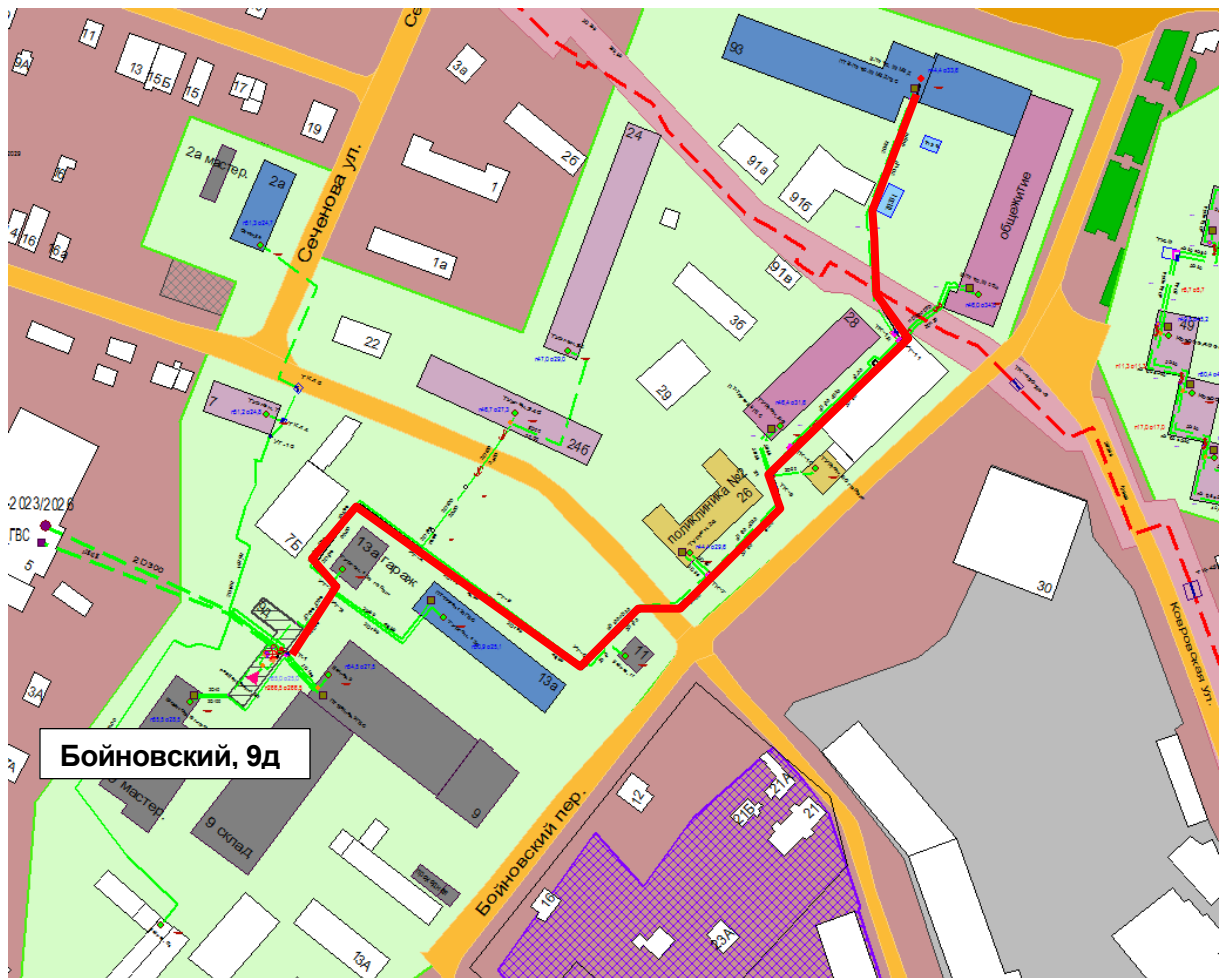
Рисунок 2.23 – Результат гидравлического расчета - расчетный путь теплоносителя от Бойновский, 9д до ПТ-Б.Печер, 93 МВД
